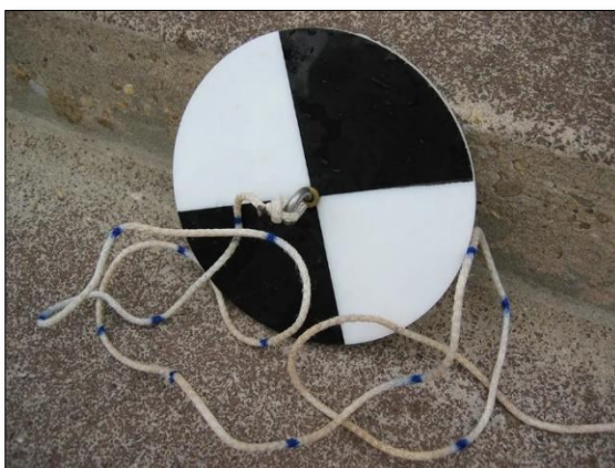
Rajah 2.2 : Piring Secchi dan meter kekeruhan
