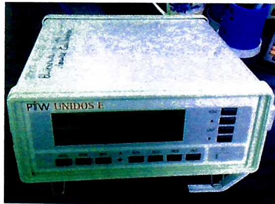
Figure 3.8 : Electrometer model UNIDOS E, Physikalisch-Technische Werkstätten (PTW)
