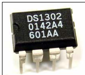
Rajah 2.10: Jam Masa Nyata (RTC) DS1302
